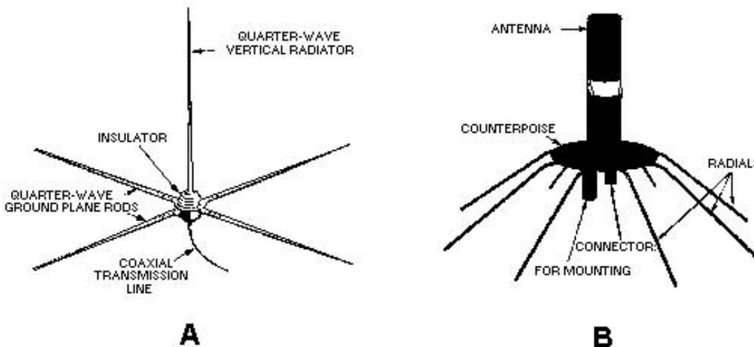
Figure 1-38.—Ground-plane antennas.
