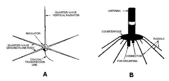
Figure 1-38.—Ground-plane antennas.
